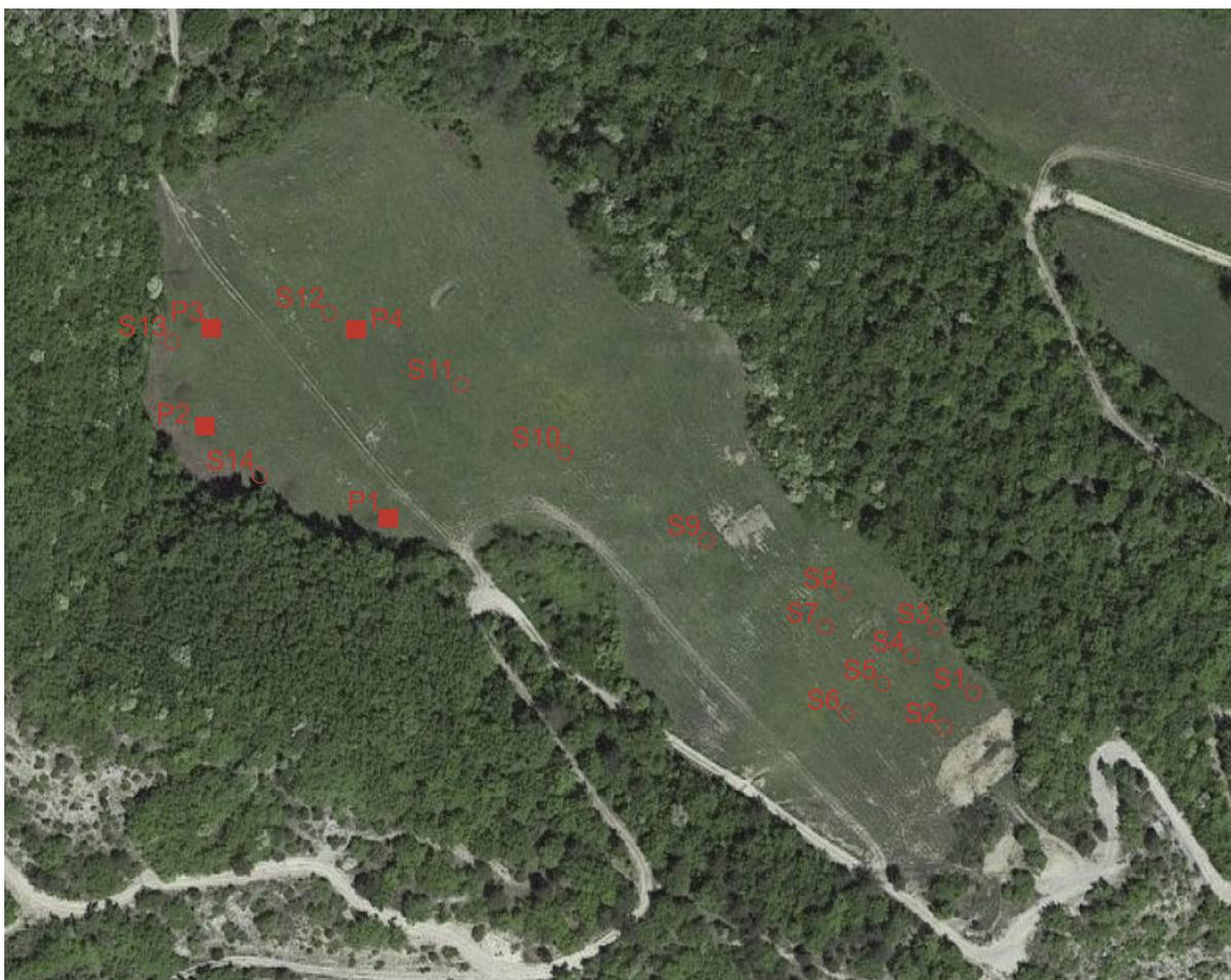
La stratigrafia completa della porzione nord è stata perciò ottenuta con le prove penetrometriche che possono essere così schematizzate:
